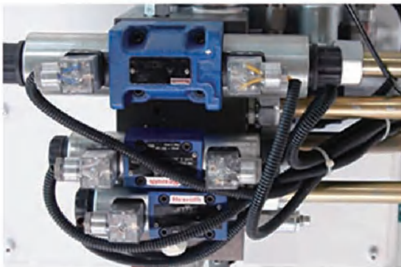
Гидравлический клапан Компактная гидравлическая система BOSCH Rexroth с пропорциональным электрогидравлическим управлением, позволяющим регулировать давление процесса и гарантировать стабильную и надёжную работу.
