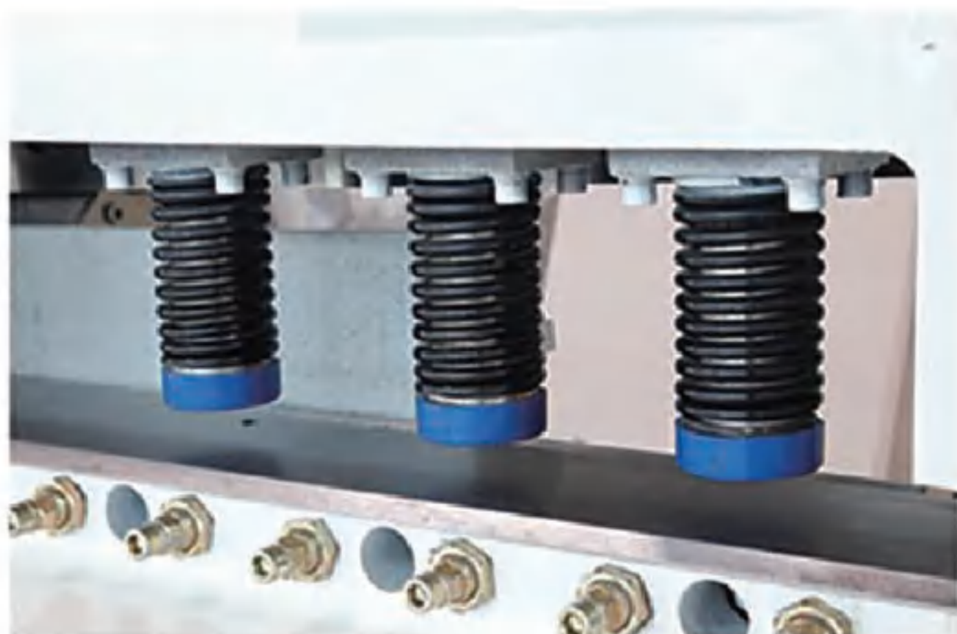
Гидравлические зажимные цилиндры Гидравлическая система зажима надёжно удерживает лист во время резки, что уменьшает вибрации и способствует обеспечению стабильного и точного результата резки.
