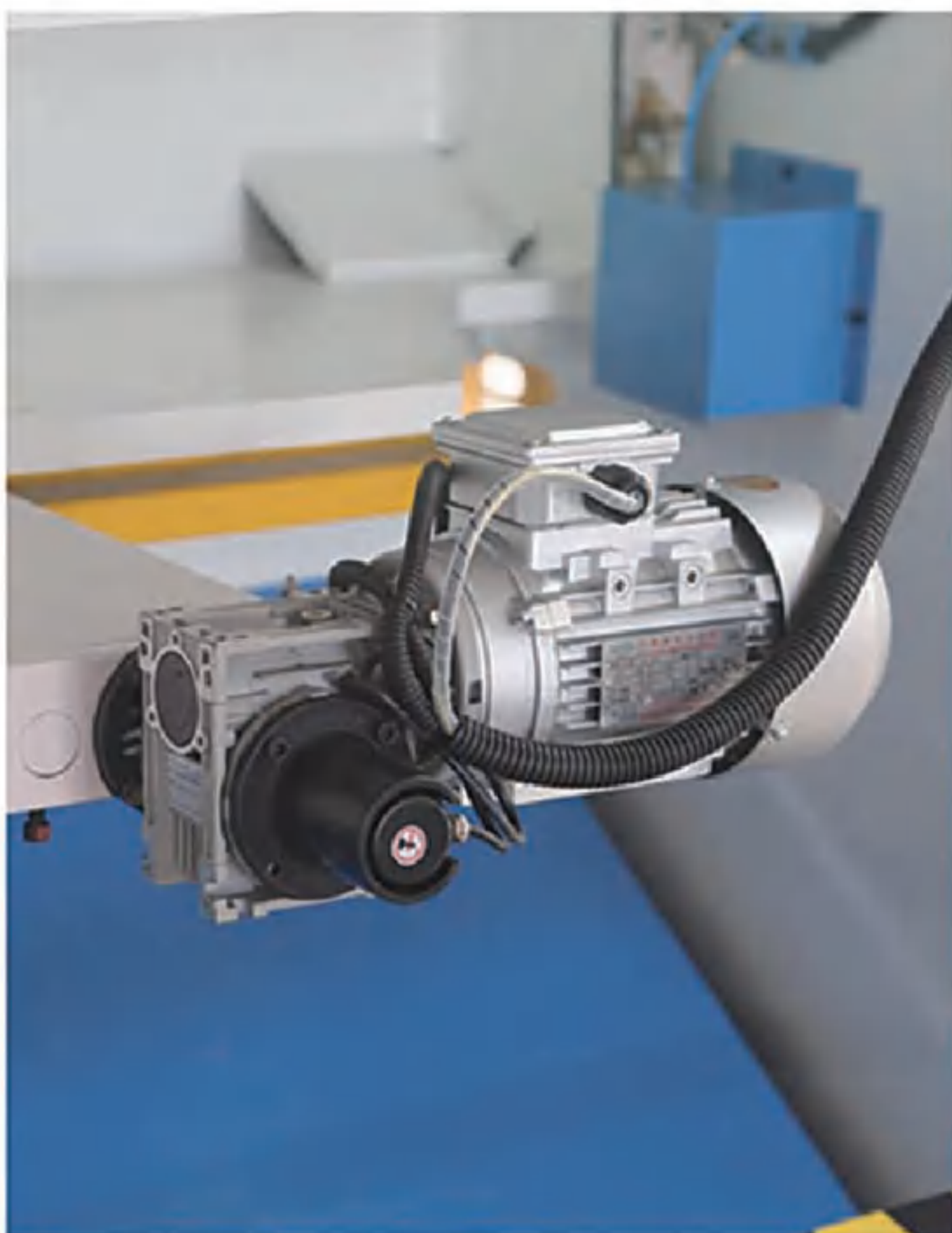
Двигатель переменного тока Двигатель переменного тока приводит шариковый винт заднего упора, обеспечивая главное движение и точное позиционирование.
